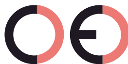
Marca CE falsa (demasiado separados)
